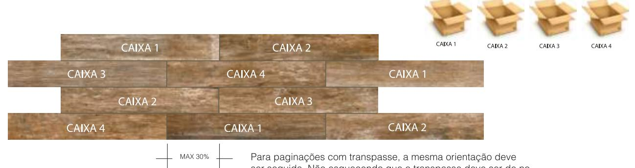
Para paginações com transpasse, a mesma orientação deve ser seguida. Não esquecendo que o transpasse deve ser de no máximo 30% do comprimento da peça.
